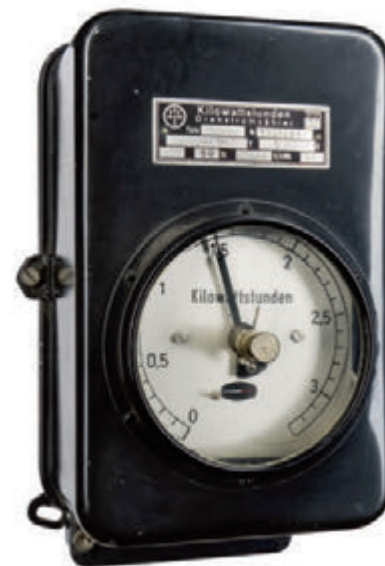
Ein Drehstromzähler von 1951
