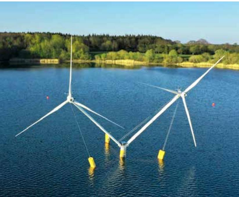
Dieses Modell soll die Offshore-Technologie revolutionieren: Die EnBW testet mit dem Ingenieurbüro Aerodyn schwimmende Windkraftanlagen. Ziel ist es, die Kraft des Windes auch in Gewässern mit größerer Tiefe zu nutzen und in Strom umzuwandeln.
